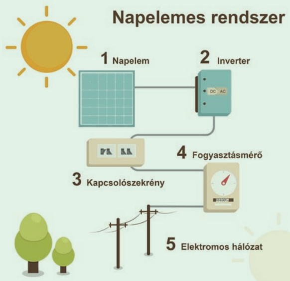
Hálózatra tápláló rendszer működési elve
